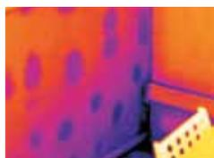
L'image thermique montre de la moisissure sur le mur intérieur, causée par une infiltration d'eau.
