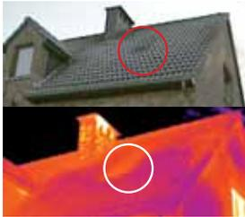
L'inspection par thermographie permet de voir un défaut d'isolation du toit. Il va maintenant pouvoir être réparé pour éviter toute fuite d'énergie supplémentaire.
