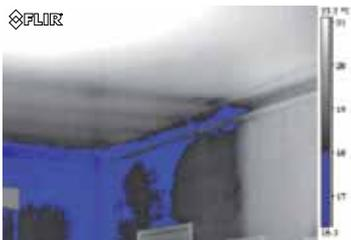
L'alarme d'humidité relative vous signale les zones où la condensation risque d'apparaître. Dans l'image ci-dessous, c'est le cas de la zone en bleu.
