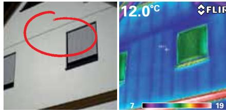
L'inspection par thermographie permet de voir un défaut d'isolation du mur.
