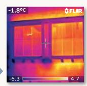
Le locataire se plaindrait d'un endroit froid dans son salon. L'image thermique à droite montre clairement que ce problème est lié à un défaut d'isolation d'une partie du mur. En isolant correctement cet endroit, le locataire pourra améliorer son confort, en économisant de l'énergie et de l'argent.
