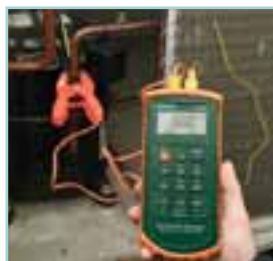
Double thermomètre de Type K pour les mesures différentielles de température dans les applications de climatisation
