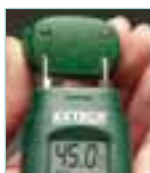
Mesure l'humidité du bois et des matériaux de construction.
