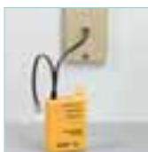
L'émetteur injecte des signaux pistables dans les câbles, contrôle les lignes téléphoniques et effectue les contrôles de continuité
