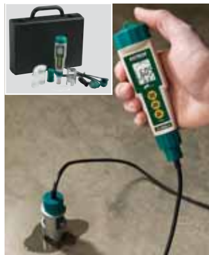
Mesure du pH du béton avec un pH-mètre équipé d'une électrode à extrémité plane avec protection métallique pour la stabilité des mesures
