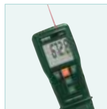
La fonction tachymètre photo mesure la vitesse de rotation des objets sans contact avec la surface, en utilisant un faisceau laser et des bandes réfléchissantes
