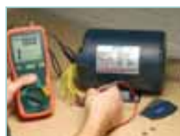
Mesure la résistance d'isolement des moteurs
