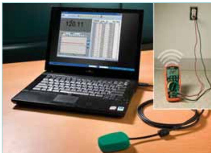
Transmission des données en continu sans fil de votre instrument de mesure à votre PC en temps réel.
