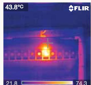
L'image thermique montre clairement un fusible surchauffé ou défectueux. Il est important de localiser le problème et de procéder à la réparation pour éviter qu'une ligne de production s'arrête entièrement.
