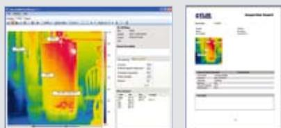
Le logiciel **QuickReport™ pour PC** permet d'analyser la température en chaque pixel des images produites par les caméras FLIR
