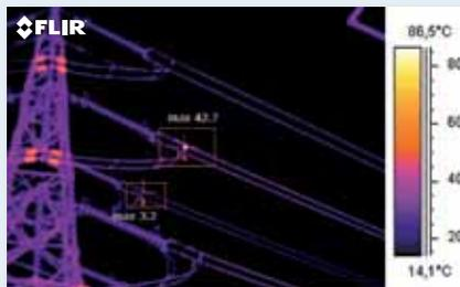
Image de 320 x 240 pixels, sensibilité thermique 50 mK. Le nombre de pixels étant plus grand, le relevé de température au point chaud gagne en exactitude.
