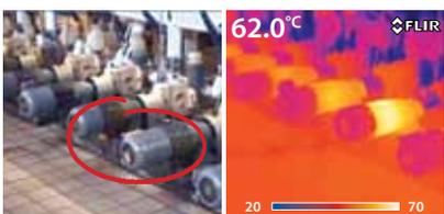
Vérification mécanique d'un moteur électrique au moyen de la FLIR série E.
