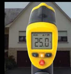
Pyromètre : mesure de température en un point
