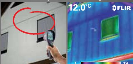
L'inspection par thermographie permet de voir un défaut d'isolation du mur.
