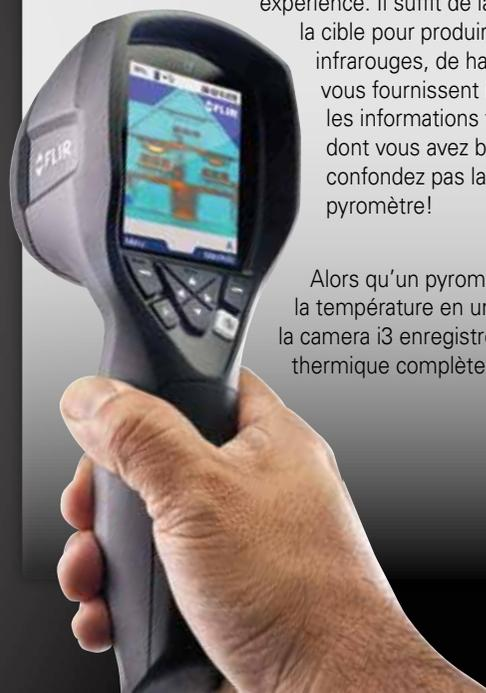
Alors qu'un pyromètre relève la température en un seul point, la camera i3 enregistre une image thermique complète.
