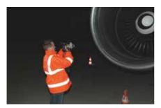
Inspection d'un avion avec une caméra thermique FLIR.
