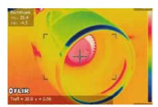
Image thermique d'un moteur. Sa lecture nécessite des connaissances spécifiques, car les matériaux d'un avion présentent des émissivités différentes.
