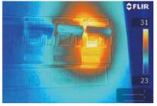
Image thermique du même fusible surchauffé, avec la fonction MSX. Le texte sous le fusible est lisible, ce qui facilite son identification et sa réparation.
