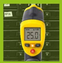
Thermomètre IR : la température en un point
