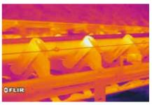
Image visible et image thermique d'un roulement à billes qui surchauffe et devrait être remplacé.
