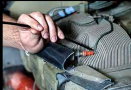
Inspection d'un cylindre de moteur d'avion avec la VSA2-1M
