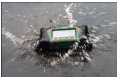
Boîtier étanche résistant aux chutes conforme aux normes IP67
