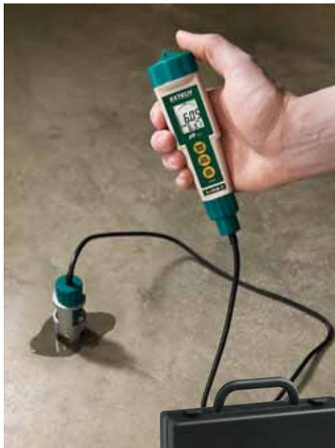
Mesure du pH du béton avec un pH-mètre équipé d'une électrode à extrémité plane avec protection métallique pour la stabilité des mesures
