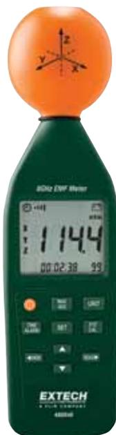
**Mesure de rayonnements haute fréquence de 10 MHz à 8 GHz**
