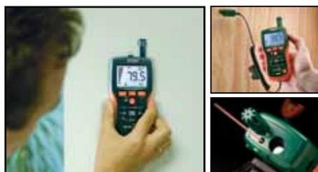
Mesure de l'humidité à l'aide de la technologie sans pointe non invasive ou avec la pointe de mesure à distance et la température de surface sans contact au moyen du thermomètre IR intégré
