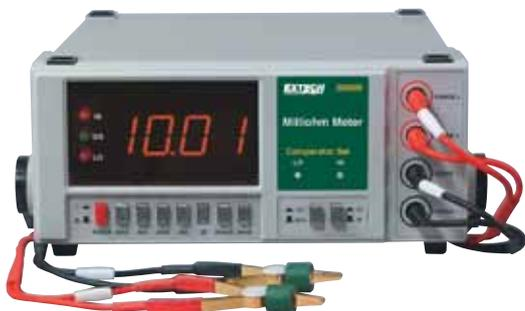
L'appareil de mesure de laboratoire fournit une résolution jusqu'à  $0,01 \text{ m}\Omega$
