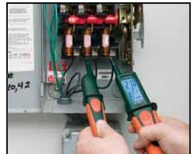
Les testeurs de tension multifonctions mesurent la tension au niveau des prises et réalisent un test de séquence triphasé. Les caractéristiques incluent une lampe témoin intégrée.
