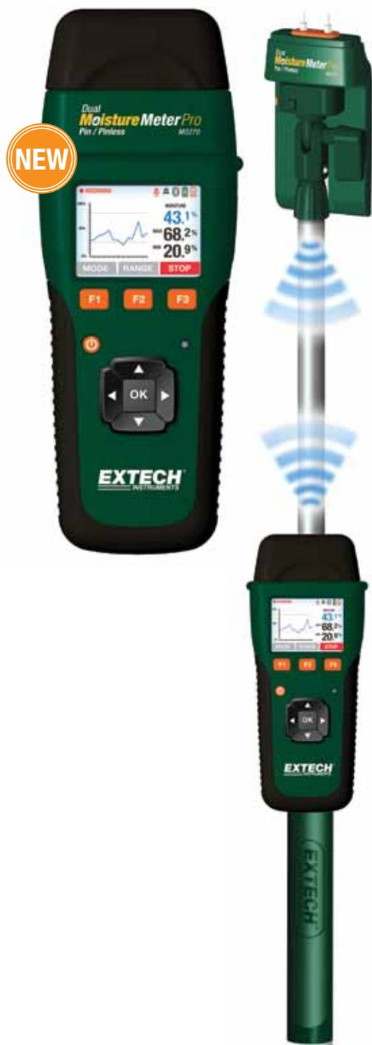
Les données à l'écran sont transmises par les capteurs avec/sans pointes détachables et peuvent être visionnées jusqu'à 20 m de distance
