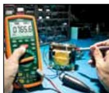
Mesure la résistance d'isolement des enroulements de transformateurs
