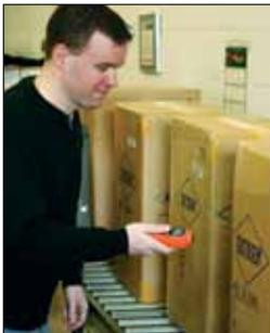
Mesure de la vitesse (tr/min) des objets en rotation et compte-tours (rotation) des objets en mouvement.
