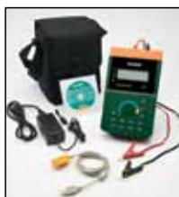
Fourni avec des câbles 4 fils avec connecteurs de pince Kelvin, pile Lithium-Polymère rechargeable, adaptateur/chargeur CA, logiciel, un câble USB et sacoche de transport
