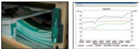
Contrôle les niveaux de température et d'humidité (RHT10). Connecteur USB qui se branche facilement à un ordinateur pour une analyse de données à l'aide du logiciel inclus
