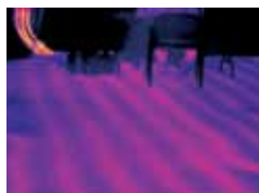
Fuites dans un réseau de chauffage urbain.
