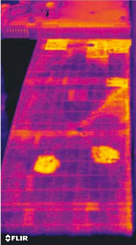
Humidité dans l'isolation d'un toit en terrasse.
