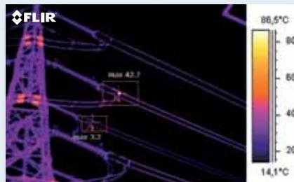
Image de 320 x 240 pixels, sensibilité thermique 50 mK. Le nombre de pixels étant plus grand, le relevé de température au point chaud gagne en exactitude.
