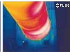
Détérioration du matériau réfractaire d'un four à ciment rotatif
