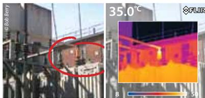
Inspection d'un transformateur au moyen de la fonction Fusion Image dans l'image.
