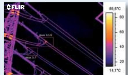
Image de 640 x 480 pixels, sensibilité thermique < 45 mK. Remarquez comme le point chaud est maintenant clairement visible. L'augmentation du nombre de pixels a encore amélioré l'exactitude du relevé de température en ce point. Il n'y a plus aucun doute sur l'existence d'un problème.
