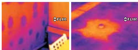
L'image thermique montre de la moisissure sur le mur intérieur, causée par une infiltration d'eau.
