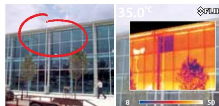
L'inspection thermographique révèle une fenêtre installée de façon incorrecte.
