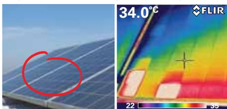
les défauts des panneaux Photovoltaïques sont clairement visibles avec l'image thermique.
