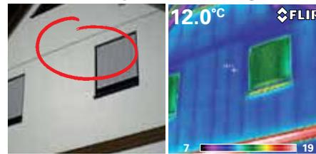
L'inspection thermographique permet de voir un défaut d'isolation du mur.
