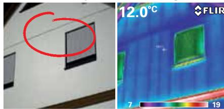
L'inspection thermique permet de voir un défaut d'isolation du mur.
