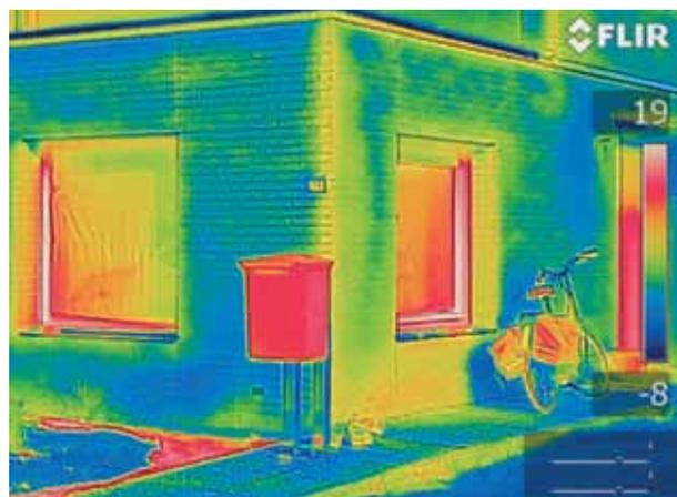
Image thermique du même bâtiment, avec la fonction MSX. On remarque qu'un plus grand nombre de détails sont visibles, ce qui permet de repérer les grilles d'aération et de voir la structure en briques. La fonction MSX donne de la profondeur à vos images thermiques.
