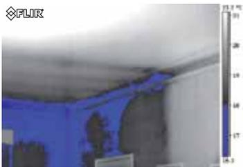
L'alarme d'humidité relative vous signale les zones où la condensation risque d'apparaître. Dans l'image ci-dessous, c'est le cas de la zone en bleu.
