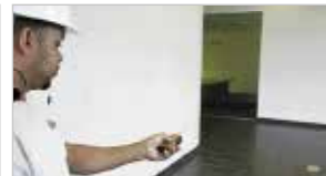
Appareil de mesure de distance par laser avec outils intégrés pour effectuer un calcul rapide des surfaces y compris dans les endroits difficiles d'accès.
