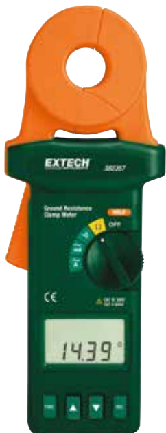
Vérifier la résistance de grilles de terre de tours de transmission et de tours de communication cellulaire
