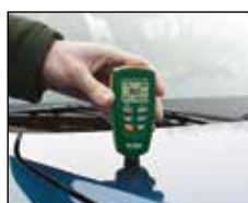
Mesure de l'épaisseur de la peinture automobile
