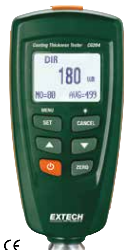
Mesure de l'épaisseur de la peinture automobile
