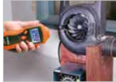
Mesure de la vitesse (tr/min) des objets en rotation et compte-tours (rotation) des objets en mouvement.
