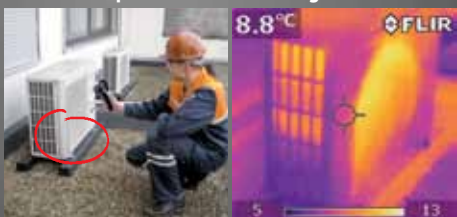
Vérification rapide et facile d'une installation de chauffage, de ventilation et de climatisation.
