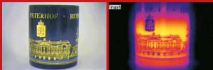
*L'image thermique pourrait laisser croire que la peinture dorée est plus froide que le reste de la surface de la tasse. En réalité, elle est exactement à la même température. La différence d'intensité du rayonnement thermique provient de la différence d'émissivité.*
