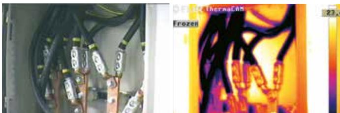
*Cette image thermique est étrange pour qui ignore les circonstances de son enregistrement. Les câbles ne sont parcourus par aucun courant. Ils sont situés dans une pièce chauffée, et les surfaces métalliques non oxydées reflètent la température ambiante.*
