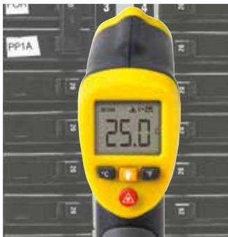
**Thermomètre IR, mesure de température en un seul point**
