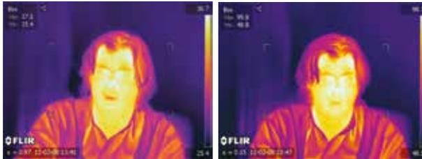
Sur l'image thermique de gauche, l'émissivité est réglée sur la valeur de la peau humaine (0,97). Le relevé de température est correct : 36,7 °C. Sur l'image de droite, une émissivité incorrecte (0,15) produit un relevé de température fantaisiste : 98,3 °C.
